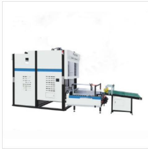
如何解决翻转机收紧力不足的问题？1、在经过长时间使用后，送进压轮表面网纹就会受到很大的磨损，还有风动马达内叶片也很容易被磨损，磨损程度严重就需要及时替换被磨损的部件。2、翻转机的在工作时不能够进行收紧也可能是送进压轮与垫轮之间间隙大小不合适，这是我们应根据实际需要调整间隙。3、收紧力不足也可能是换向阀有泄漏所造成的，马达内进入气体，其工作气压就会偏低，不能很好的起到收紧的作用，我们需要及时替换密封件。
